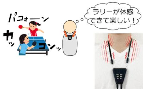
競技音や観客の歓声などの音を振動に変換し、音の方向、強弱、リズムなどを「体で感じられる」デバイス。
